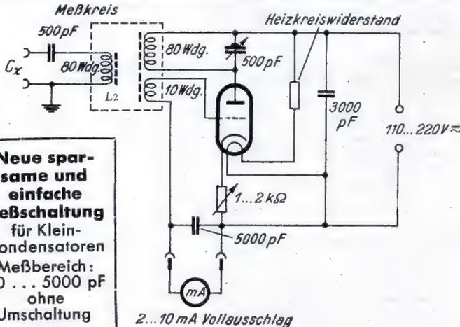
Links: Bild 18. Einfachste Meßschaltung für Kleinkondensatoren.
