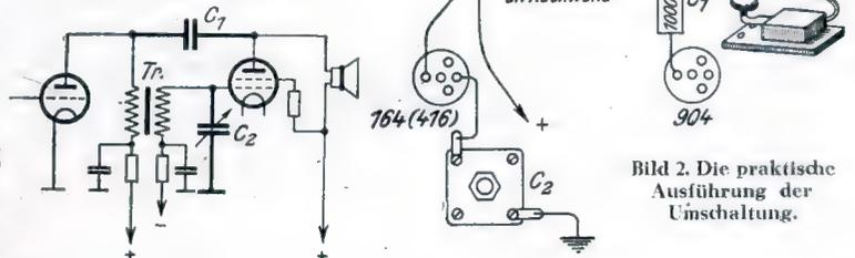
Bild 2. Die praktische Ausführung der Umschaltung.
