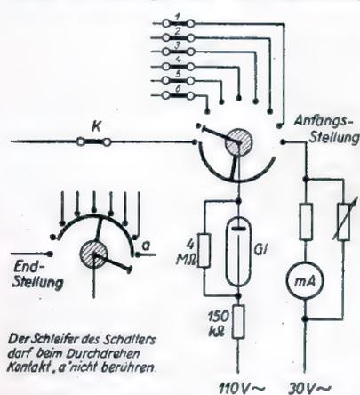
Bild 2. Schaltung der Zusatz-einrichtung für die Elektrodenschlußprüfung.
