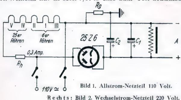
Bild 1. Allstrom-Netzteil 110 Volt.
