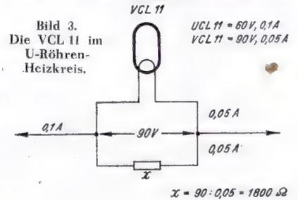
Bild 3. Die VCL 11 im U-Röhren-Heizkreis.
