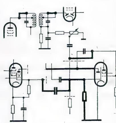
Bild 3. Dreipolteil der ECL 11 als Oszillator geschaltet, Nf-Stufe entfernt und 2. Bandfilter auf höheres Signal umgeschaltet.
