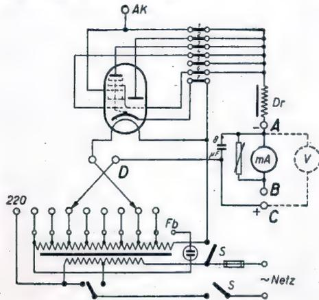
Bild 1. Die geänderte Schaltung des Gerätes M 1 für die Verwendung zur Prüfung von Elektrolytkondensatoren und dgl.
