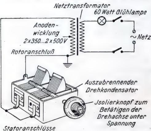
Bild 17. Ausbrennen von verstaubten Drehkondensatoren mit Hochspannung.
