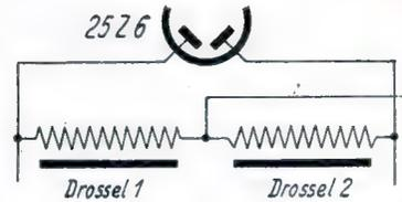
Bild 3. So lassen sich zwei Drosseln verwenden.
